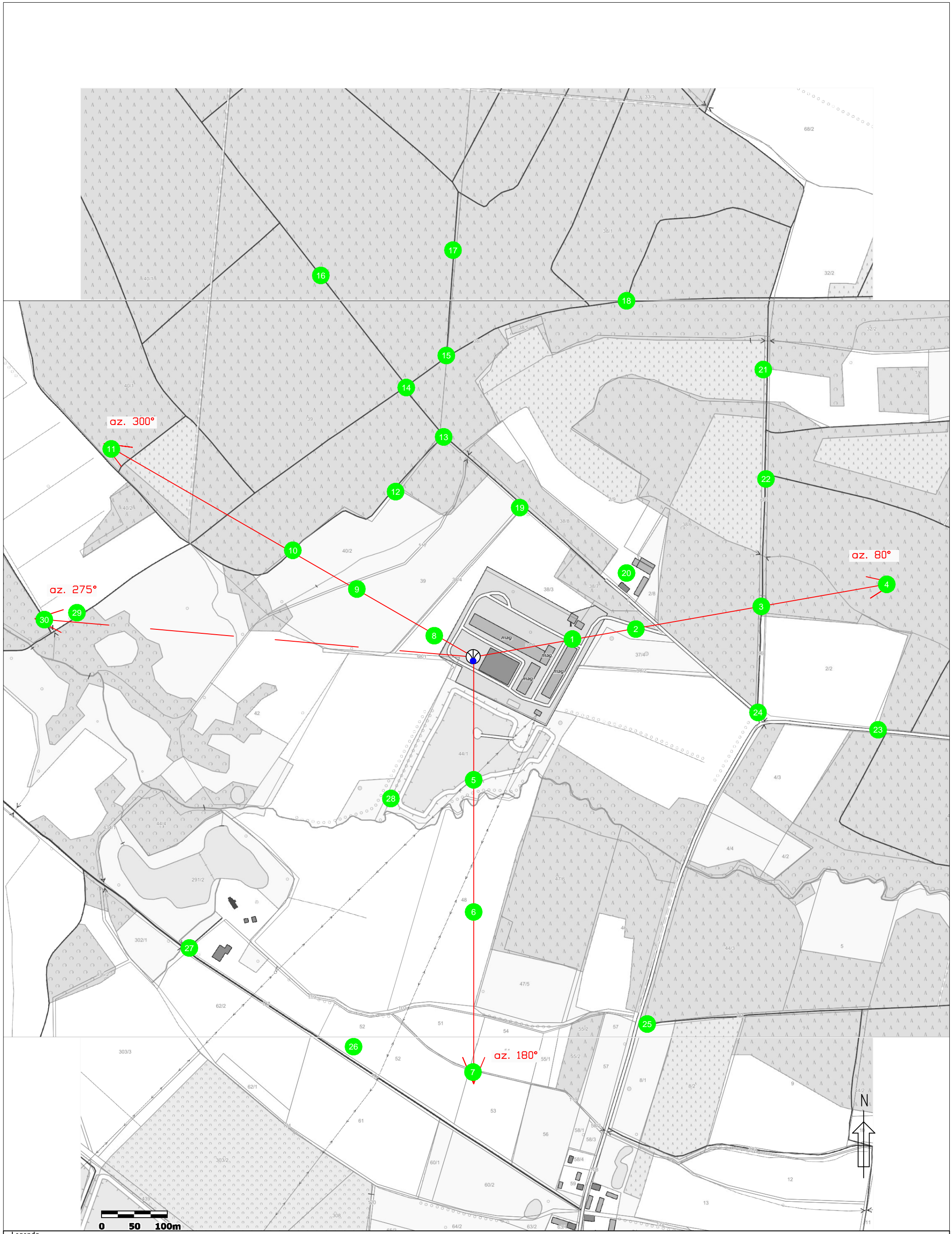
Rys.1 Lokalizacja pionów pomiarowych
