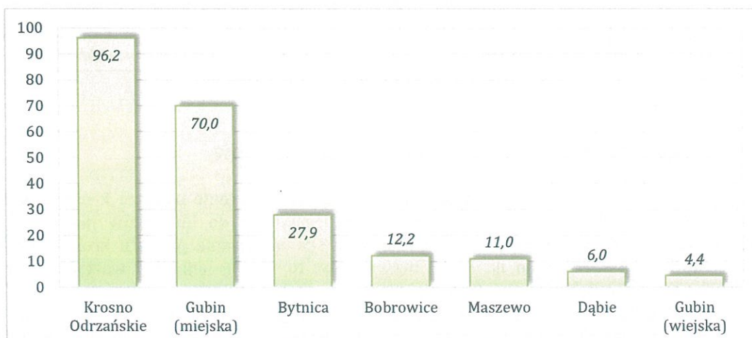
Wykres 18. Długość czynnej sieci kanalizacji sanitarnej na terenie poszczególnych gmin powiatu krośnieńskiego (stan na 31.12.2021 r.) [km]
